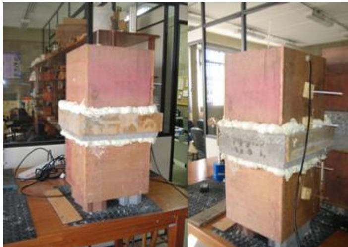
Figura 4: Corpo de prova preparado para teste de isolamento térmico.
