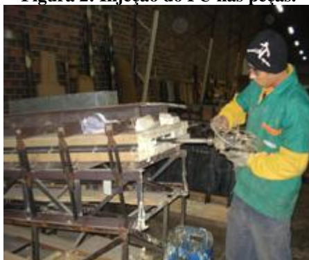
Figura 2: Injeção do PU nas peças.
