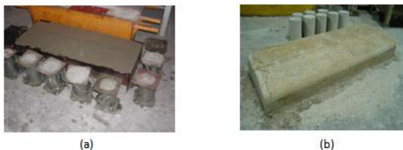
Figura 3: (a) Meio-fio e corpos-de-prova confeccionados; (b) Meio-fio e corpos-de-prova desmoldados.
