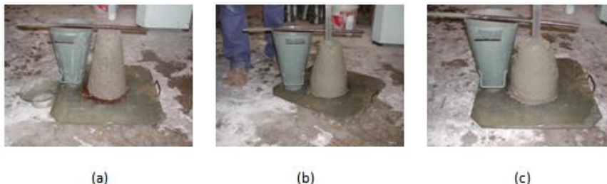
Figura 2: Execução do ensaio de abatimento: (a) 0mm; (b)50,0mm; (c)80,0mm.
