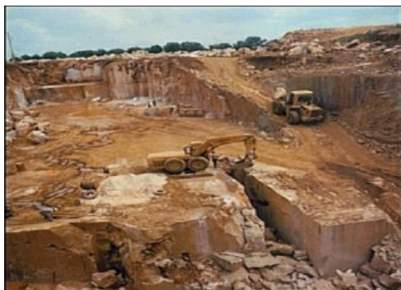
Figura 2: Primeira etapa do processo: desmatamento inicial e as escavações
