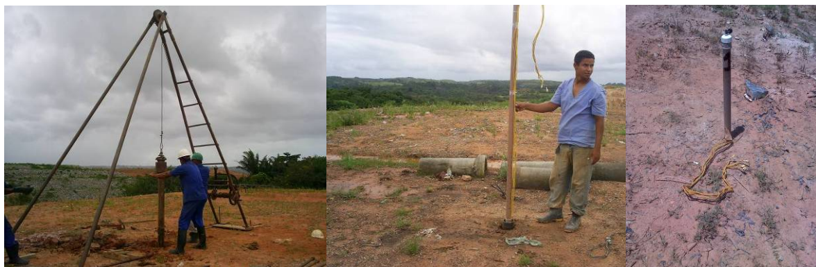
Figura 03 – Ensaios SPT para instalação dos piezômetros e termopares.
