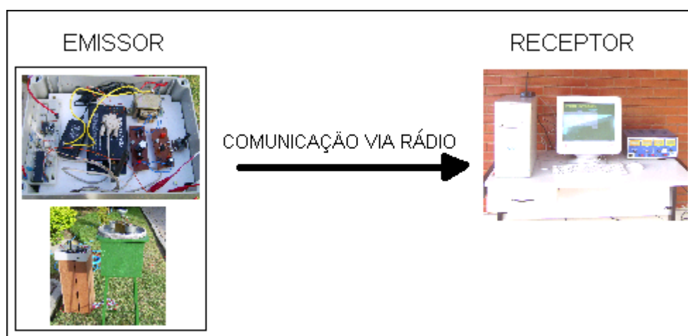
Figura 5: Comunicação Via rádio ente circuito eletrônico e computador
