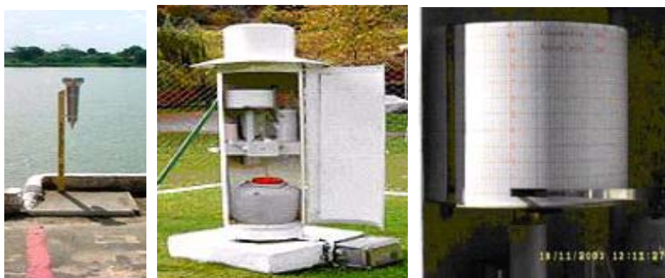
Figura 1: Tipos de Pluviógrafos
