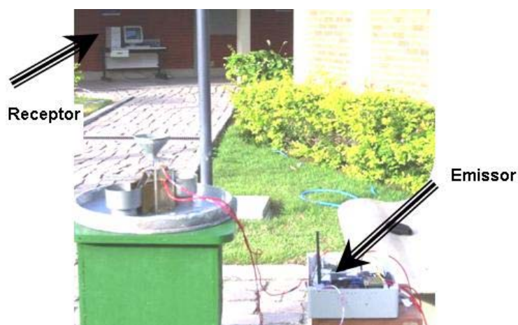
Figura 6: Teste de comunicação com o rádio
