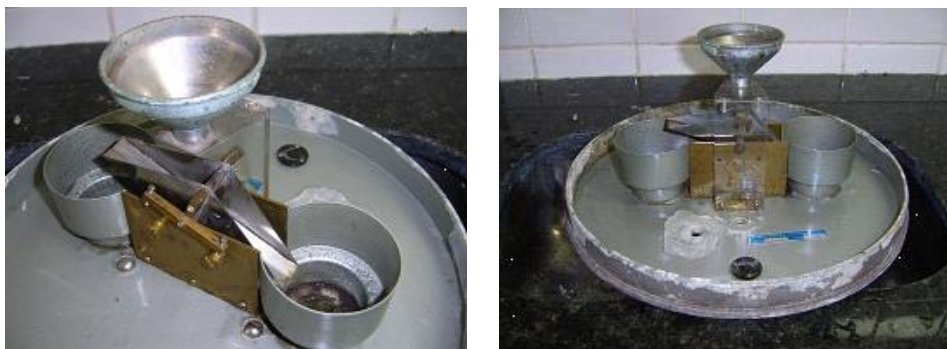
Figura 2: Pluviógrafo tipo caçamba basculante
