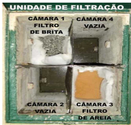
Figura 8: Unidade de filtração com camada de brita nº1 e areia média.
