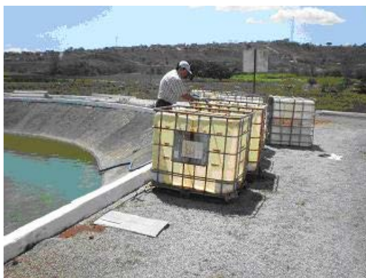
Figura 2: Montagem dos contêineres à margem da lagoa de estabilização da ETE Matozinhos e o enchimento dos mesmos com a amostra de efluente.
