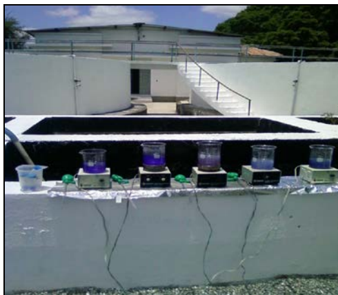
FIGURA 2: Foto do processo para avaliar a degradação do corante na presença da radiação solar.
