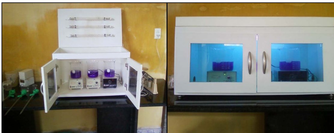
FIGURA 2: Foto do reator fotocatalítico usado para avaliar a degradação do corante utilizando os catalisadores preparados.
