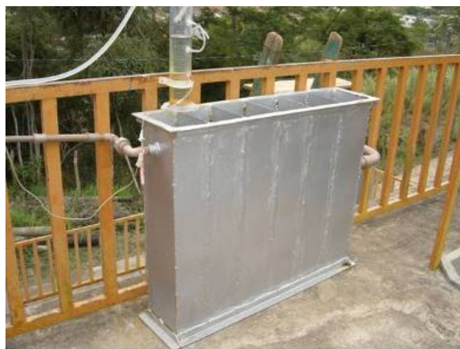
Figura 2 – Vista lateral do floculador da ETA Piloto.
