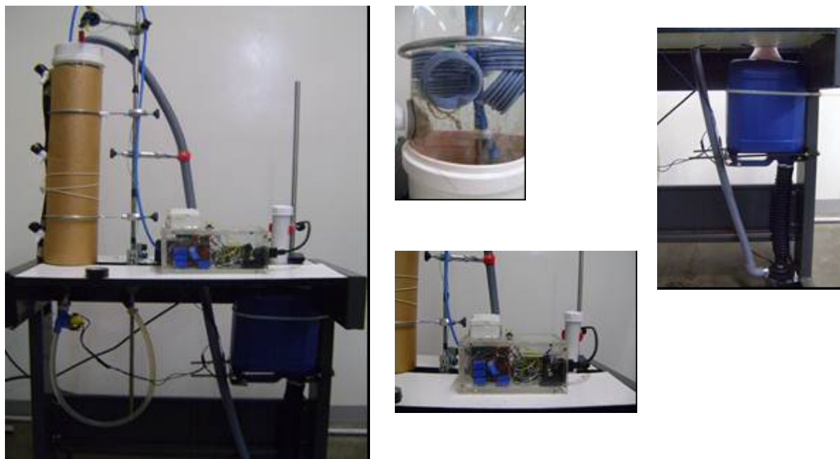
Figura 1 – Sistema reacional e detalhes do leito fixo, controle de processo e bombeamento do afluente.
