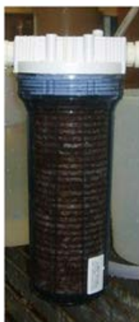
Figura 4: Filtro cartucho comercial após teste de longa duração.
