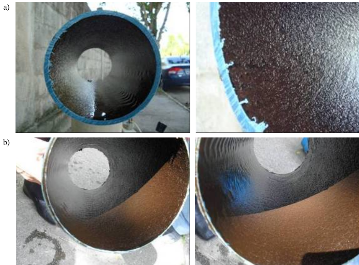
Figura 8: Incrustação na saída do fluxo de água do corpo-de-prova 01 na primeira campanha (a) e na segunda campanha (b).
