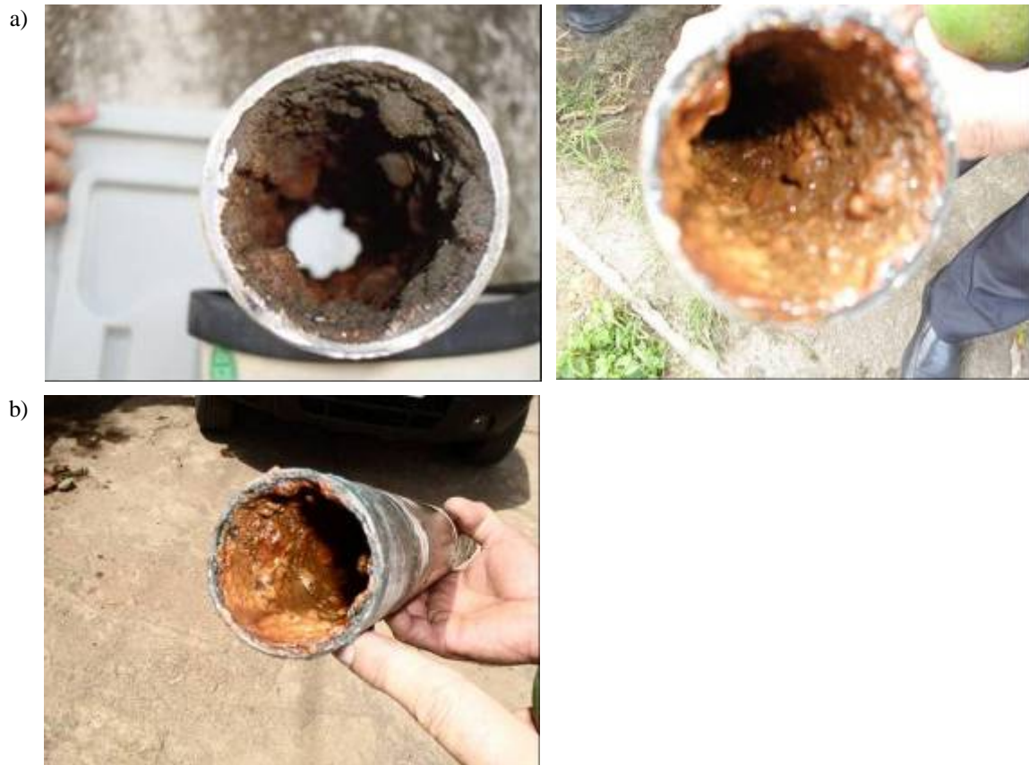
Figura 10: Incrustação na saída do fluxo de água do corpo-de-prova 02 na primeira campanha (a) e na segunda campanha (b).
