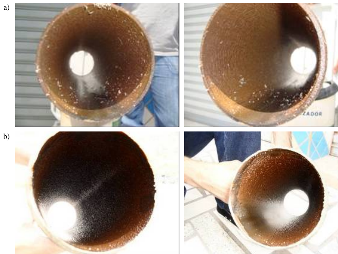
Figura 13: Incrustação na entrada do fluxo de água do corpo-de-prova 04 na primeira campanha (a) e na segunda campanha (b).
