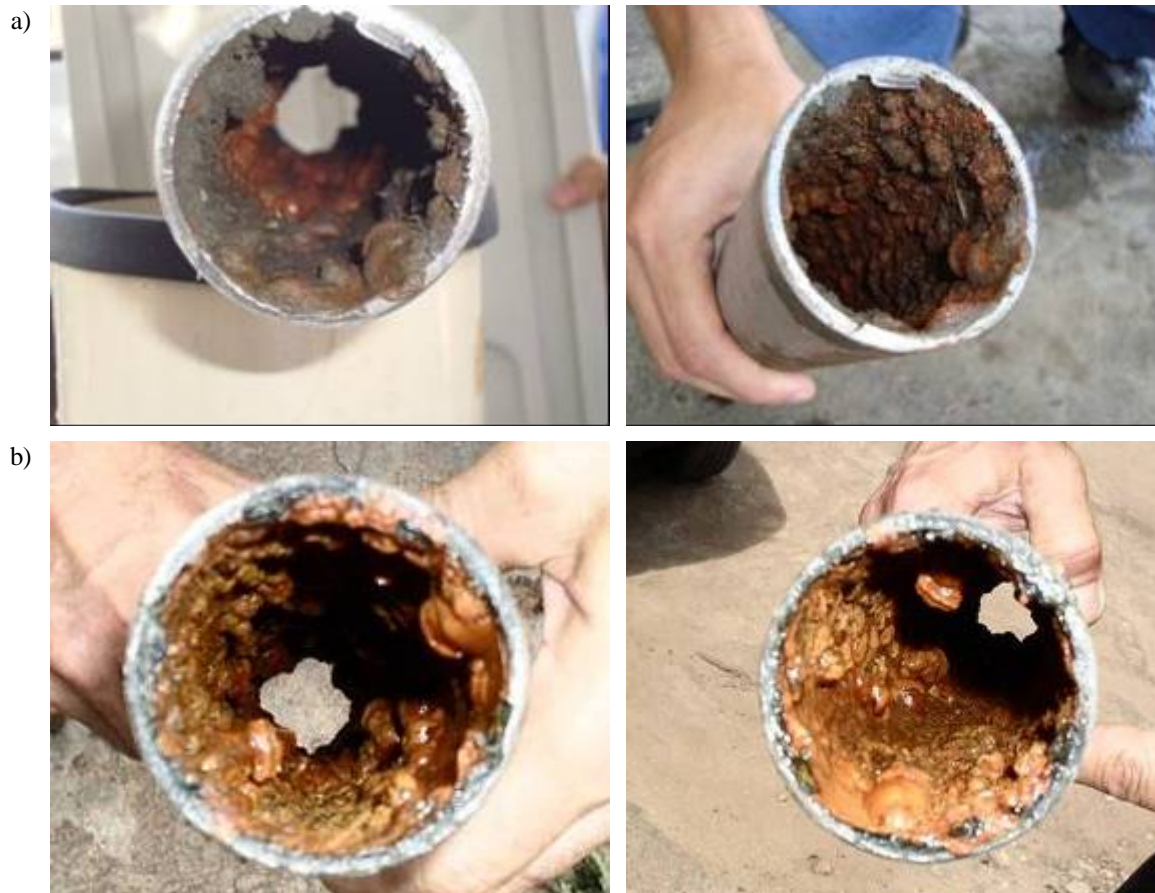
Figura 9: Incrustação na entrada do fluxo de água do corpo-de-prova 02 na primeira campanha (a) e na segunda campanha (b).
