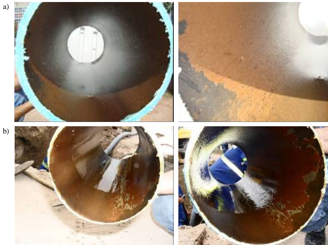
Figura 12: Incrustação na saída do fluxo de água do corpo-de-prova 03 na primeira campanha (a) e na segunda campanha (b).
