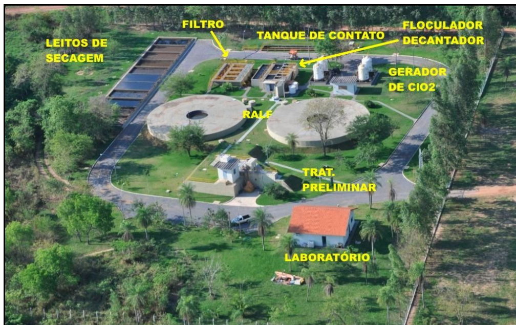
Figura 1: Foto da vista aérea da ETE Bonito com suas unidades componentes: sistema anaeróbio (RALF), físico-químico, decantação acelerada, filtração rápida e desinfecção com \text{ClO}_2 .
