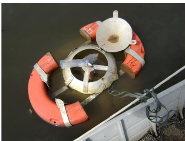
Figura 5: Posicionamento do coletor de gás, com o “bag” acoplado para início de amostragem.
