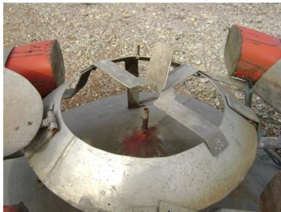
Figura 4: Detalhe do tubo de passagem do gás montado no coletor de gás.
