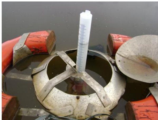
Figura 6: Medição das variáveis tempo e volume para auxílio no cálculo do fluxo de biogás.
