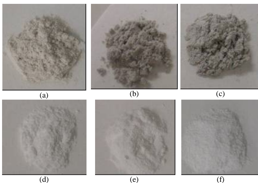
Figura 8. Adsorvente “in natura” (a) e submetido a diferentes tratamentos térmicos: (b) 500 °C por 3 horas, (c) 500 °C por 10 horas, (d) 750 °C por 6 horas e 30 minutos, (e) 1000 °C por 3 horas, (f) 1000 °C por 10 horas.
