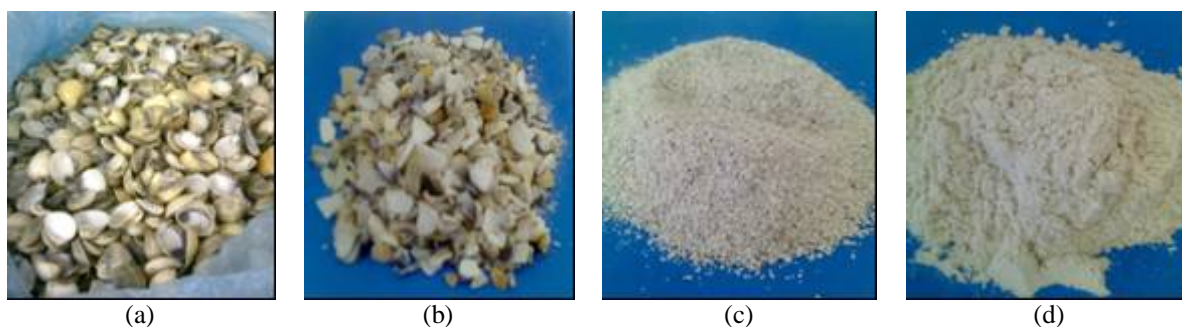
Figura 1: Conchas de amêijoas: (a) sem trituração (b) triturada em grandes partes, (c) classificadas a 20 mesh e (d) classificadas a 100 mesh.
