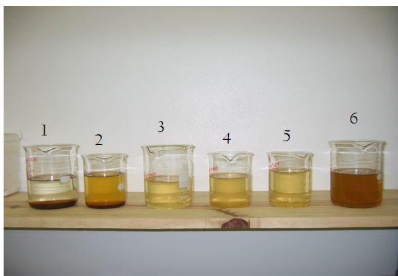
Figura 3. Foto com os efluentes pré e pós tratamento: 1 – Amostra de tratamento com \text{EF/O}_3 após 24h, 2 – Amostra de tratamento com \text{EF/O}_3 após breve agitação, 3, 4 e 5 – Amostra de tratamento com \text{O}_3 após 24h e 6 – Efluente bruto.
