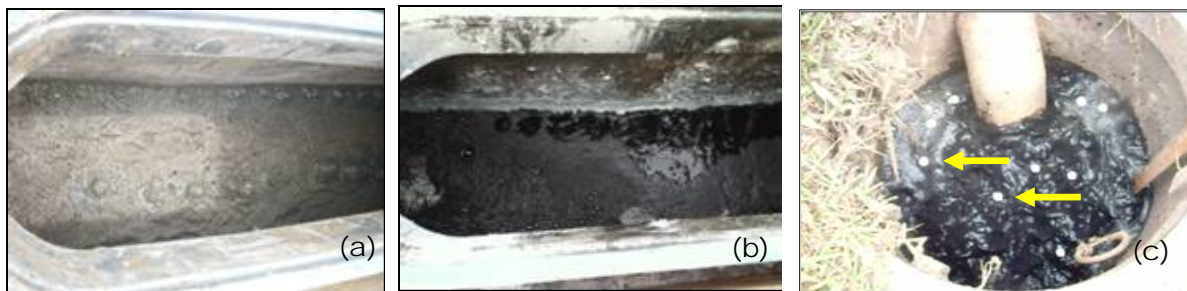
Figura 8: Visualização do acúmulo de espuma sob a escotilha do separador trifásico 3 antes (a) e após (b) o teste de remoção; (c) Verificação da remoção do material traçador (esferas de isopor) no poço de visita da linha de drenagem de espuma.
