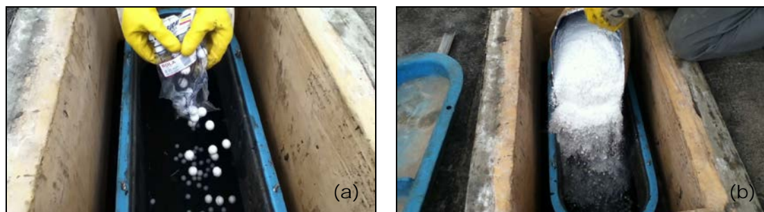
Figura 6: Introdução dos materiais traçadores nas escotilhas (a) esferas de isopor e (b) cal.
