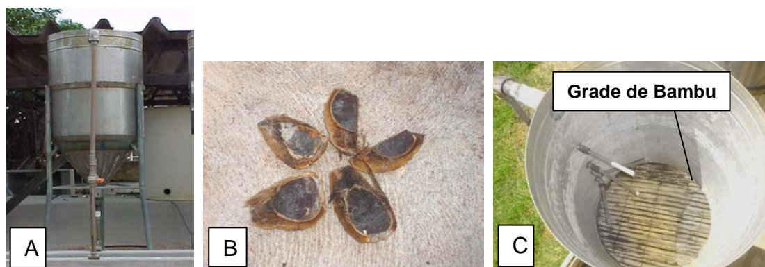
Figura 1. Vista externa do filtro anaeróbio (A), Detalhe das cascas de coco verde da espécie Cocos nucifera (B) e Detalhe da grade de bambu instalada no limite do cone e do cilindro do reator anaeróbio (C).
