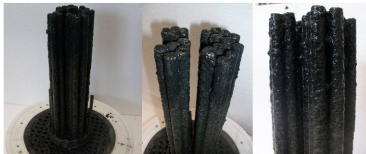
Figura 3 - Biomassa aderida aos eletrodos do anodo ao final da operação da CCM.
