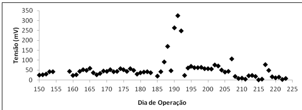
Figura 17 - Variação na geração de energia elétrica na CCM durante a Fase II
