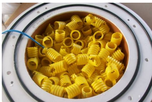
Figura 1 - Detalhe da câmara intermediária com ênfase no preenchimento com conduítes de plástico.
