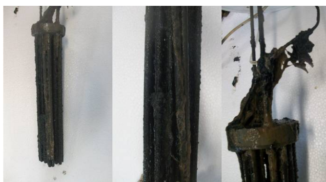
Figura 4 - Biomassa aderida aos eletrodos do catodo ao final da operação da CCM.
