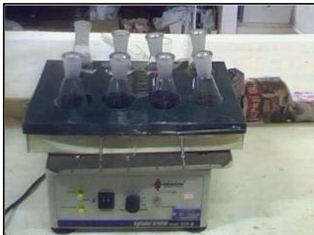
Figura 1: montagem experimental para adsorção do efluente têxtil
