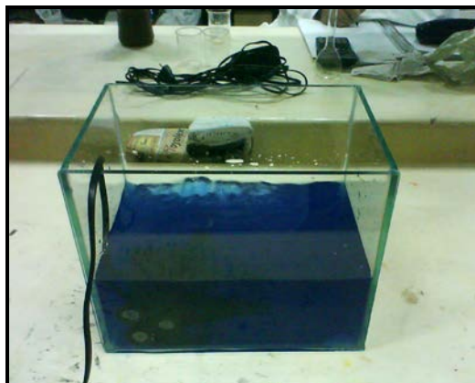
Figura 2: montagem experimental para degradação do efluente têxtil
