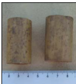
Figura 2. Fotos dos anéis de bambu utilizados como meio suporte no filtro anaeróbio de fluxo ascendente.
