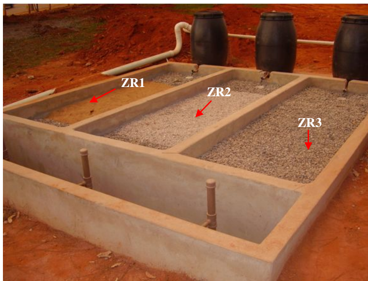
Figura 6: Detalhe dos leitos preenchidos com os substratos da estação experimental de tratamento de esgoto da unidade universitária EEC-UFG.
