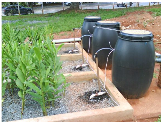
Figura 4: Detalhe das bombonas implantadas para controle de aplicação de esgoto nas zonas de raízes da estação experimental de tratamento de esgoto da unidade universitária EEC-UFG.
