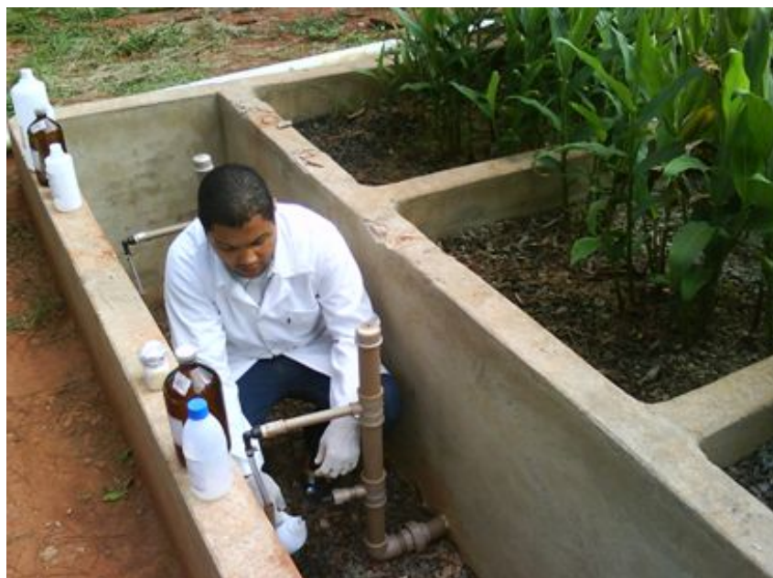
Figura 8: Detalhe do ponto de coleta de amostras para análises laboratoriais de uma das unidades zonas de raízes da estação experimental de tratamento de esgoto da unidade universitária EEC-UFG.
