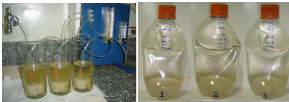
Figura 2. Detalhes dos reatores fermentativos aeróbios e anaeróbios.
