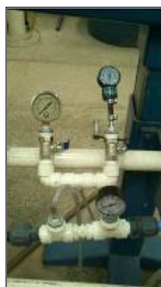
Figura 3: (a) restritor de vazão de 14 L·min -1 ; (b) instalação da peça para estudo; (c) e (d) detalhes da estrutura de medição de pressão do aparato experimental (manômetros)
