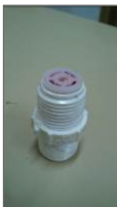
Figura 3: (a) restritor de vazão de 14 L·min -1 ; (b) instalação da peça para estudo; (c) e (d) detalhes da estrutura de medição de pressão do aparato experimental (manômetros)
