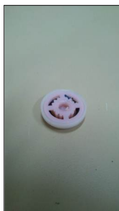
Figura 3: (a) restritor de vazão de 14 L·min -1 ; (b) instalação da peça para estudo; (c) e (d) detalhes da estrutura de medição de pressão do aparato experimental (manômetros)
