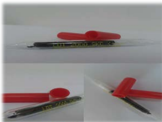
Figura 3 - Cartuchos Anasorb contendo 150 mg de carvão ativado da casca do coco.
