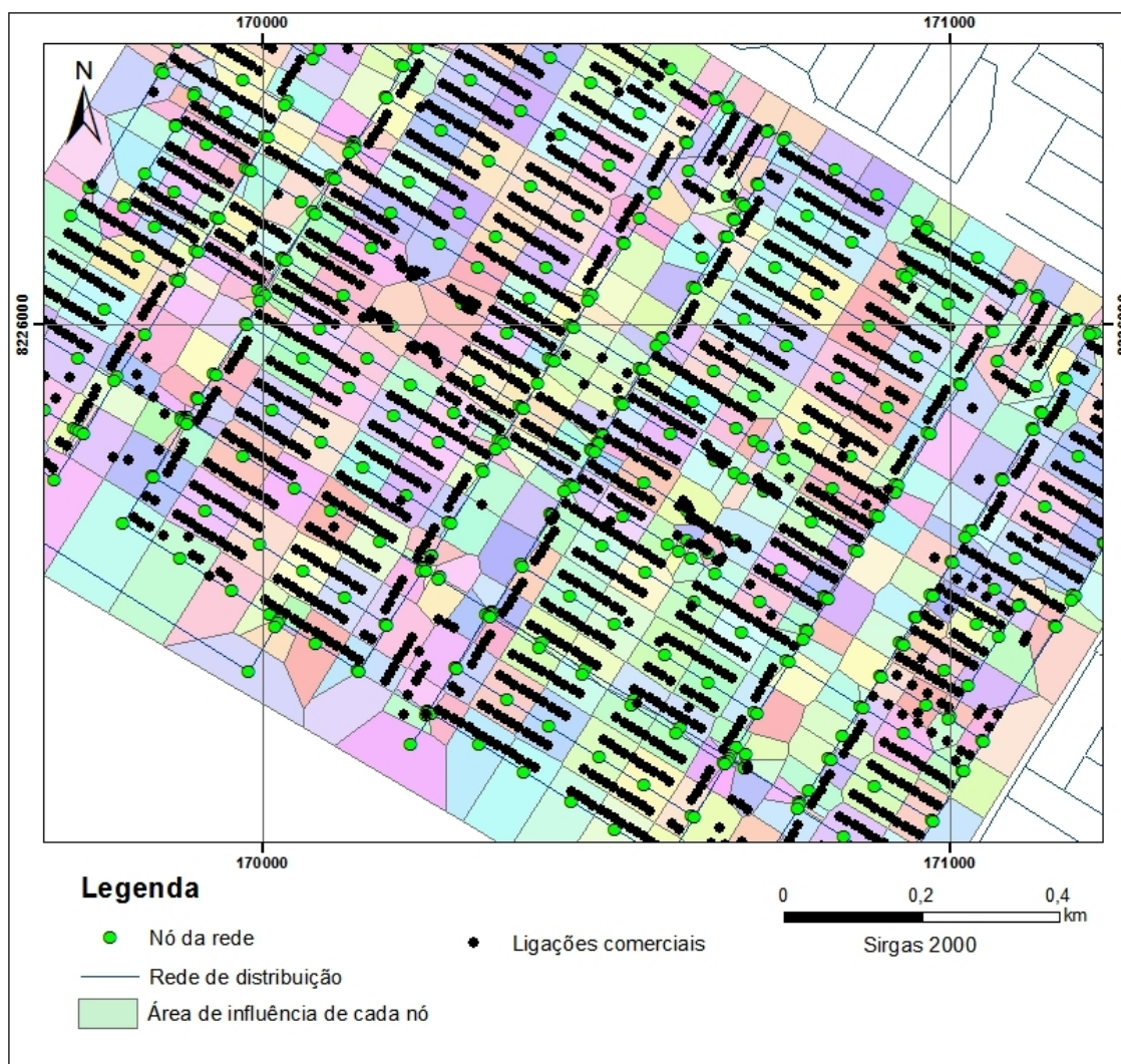
Figura 02 – Definição da correlação espacial entre nós do modelo e ligações de água para o nível de precisão 03.
