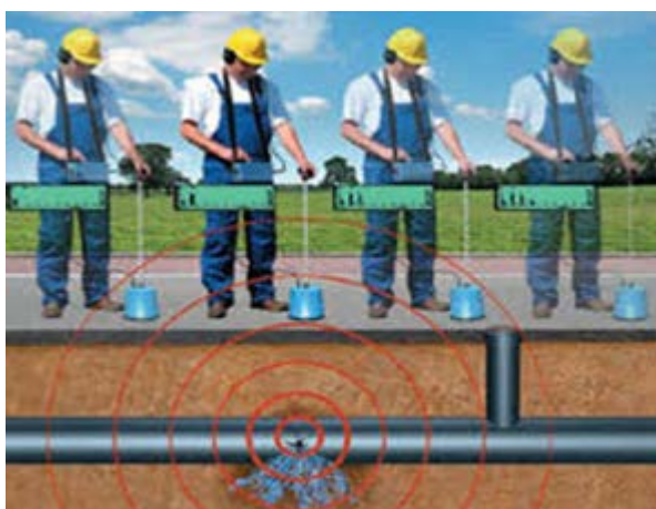
Figura 1B: Pesquisa acústica com Geofone. Fonte: www.saaemcr.com.br
