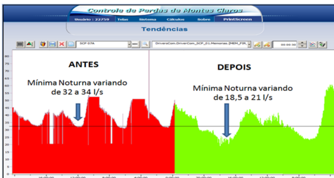
Figura 5: Gráficos de antes e depois da redução das perdas reais SCP-7A/7B. Fonte: COPASA.
