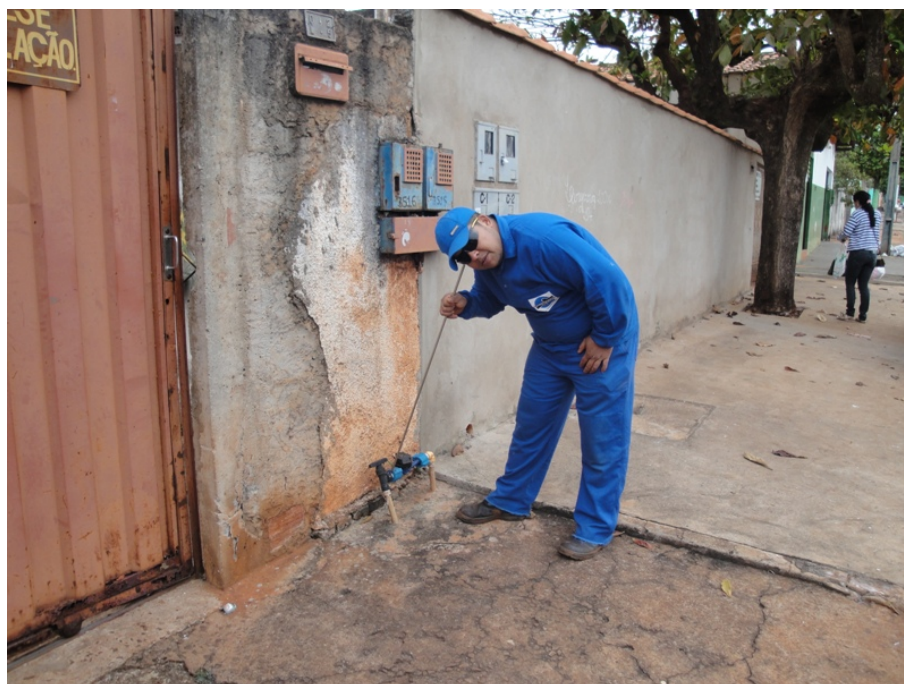
Figura 2: Uso de hastes de escuta para detecção de vazamento no cavalete
