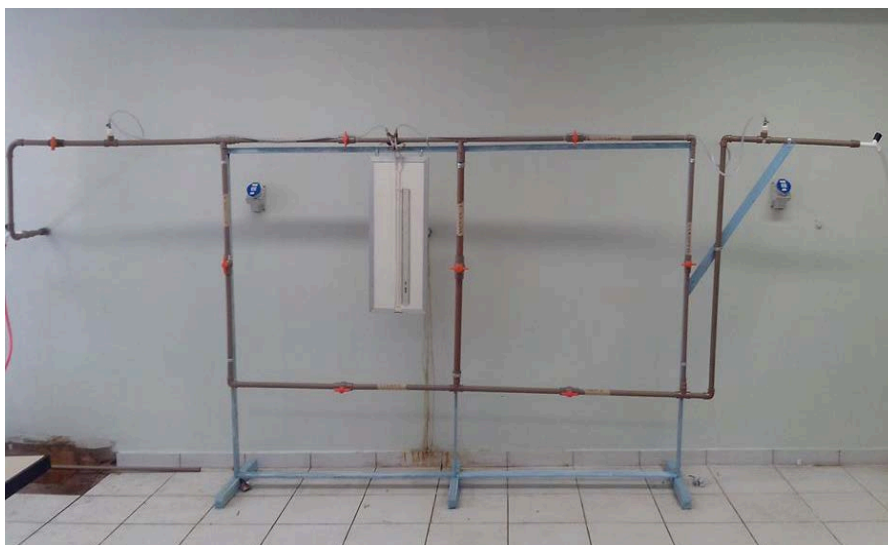
Imagem 01: Bancada de Perda de Carga. Fonte: Autores, 2014.
