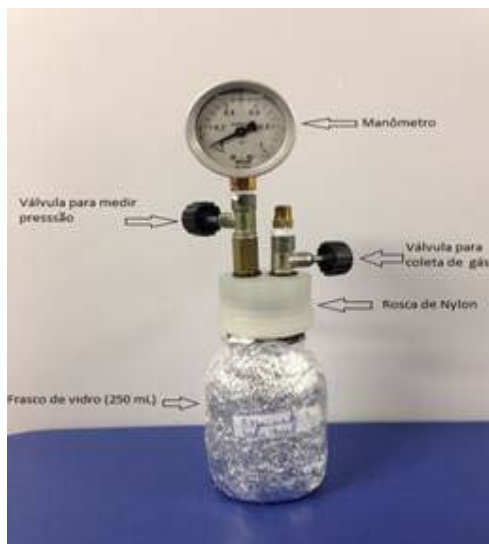
Figura 1 – Biorreator utilizado para realização do ensaio BMP.
