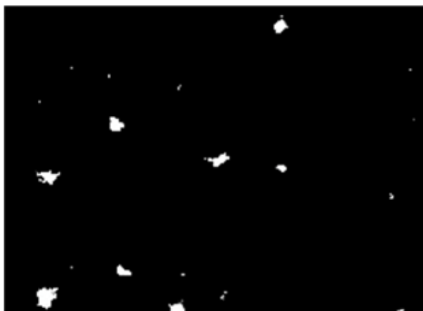
Figura 10 – Imagem após o processo de binarização; apenas pixels totalmente brancos ou totalmente pretos.
