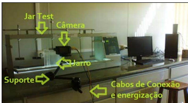
Figura 2. Arranjo experimental utilizado para elaboração do manual.
