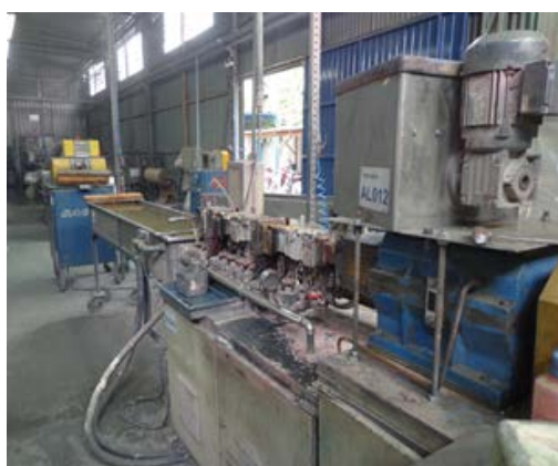
Figura 2 – Extrusora empregada na obtenção de AgNPs incorporadas na poliamida.
