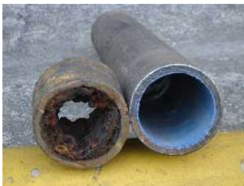
Figura 12: Comparação do estado estrutural da rede, antes e depois dos serviços.
