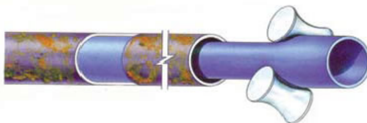
Figura 9: Inserção por Roll Down.
