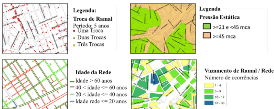
Figura 1: Exemplos das camadas Troca de Ramal, Pressão Estática, Vazamento no Ramal/Rede e Idade de Rede.
