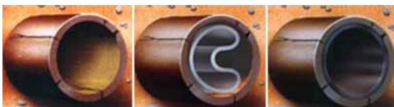
Figura 8: Inserção por Compact Pipe ou U-Liner.
