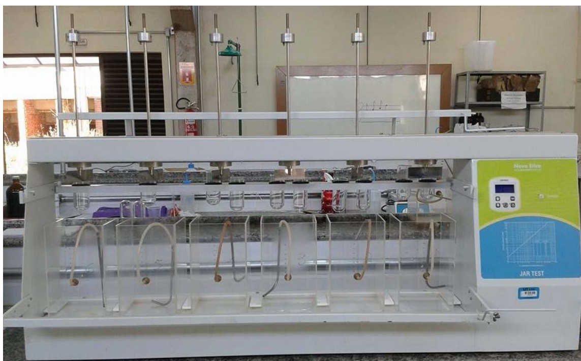
Figura 1 – Equipamento jar test utilizado nos ensaios de coagulação/floculação e decantação.
