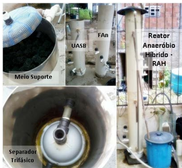
Figura 1: Detalhamento do Reator Anaeróbio Híbrido – RAH
