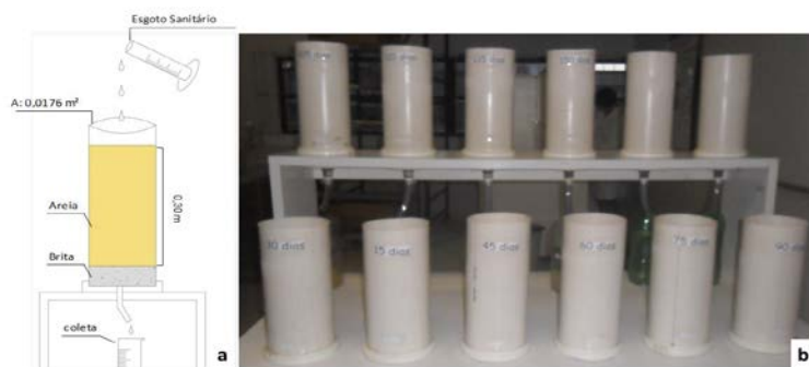
Figura 1: Colunas de areia de fluxo vertical. a) ilustração do perfil vertical das colunas; b) foto do experimento.
