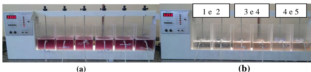
Figura 1: (a) Efluente sintético. (b) Efluente tratado. Tratamento com coagulante sintético em sua dosagem ótima (1-2), tratamento com uma dosagem inferior de coagulante sintético e solução de cacau (3-4) e, tratamento com uma dosagem inferior de coagulante sintético e solução de quiabo (5-6).
