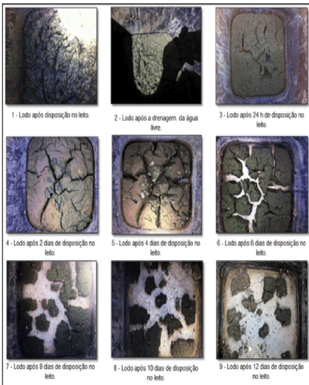
Figura 11 - Fotografias do lodo de biomassa algal na sequência do processo de desaguamento na planta piloto montadas com Blocos Drenantes.
