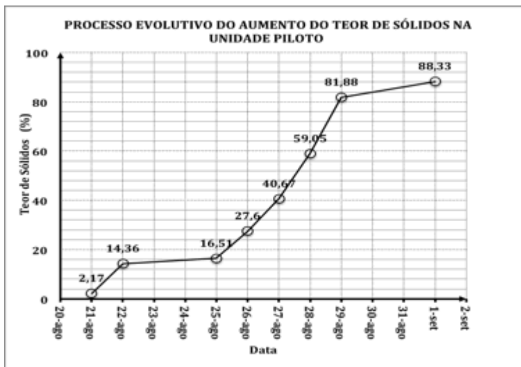
Figura 8 - Gráfico da evolução do teor de sólidos de uma corrida no período de 21/08/2014 a 28/08/2014 no sistema de desaguamento das unidades pilotos montadas com Blocos Drenantes com volume de lodo de 16L.
