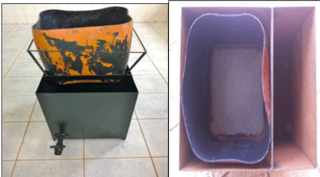
Figura 1 - Unidade Piloto do Sistema de Desaguamento de Blocos Drenantes na direita temos a vista frontal e na imagem da esquerda a vista superior.
