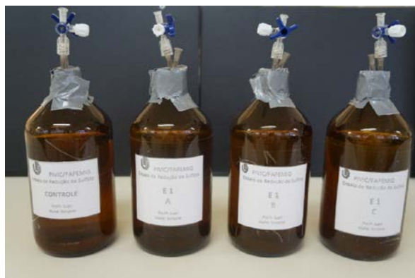
Figura 2 - Frascos âmbar para ensaios em batelada.
