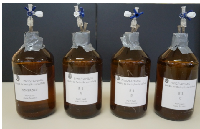
Figura 2 - Frascos âmbar para ensaios em batelada.
