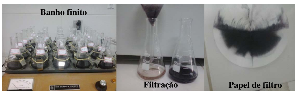
Figura 2: Representação do processo de banho finito e filtração do tratamento
