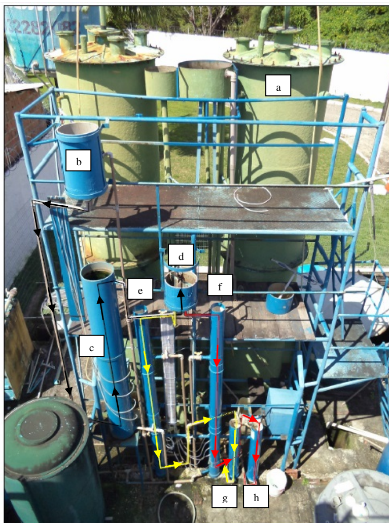
Figura 1- Esquema do sistema de filtração.
