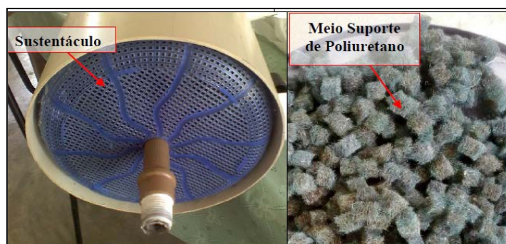
Figura 2: Sustentáculo e esponjas sintética cortadas utilizadas como meio suporte no RAH.
