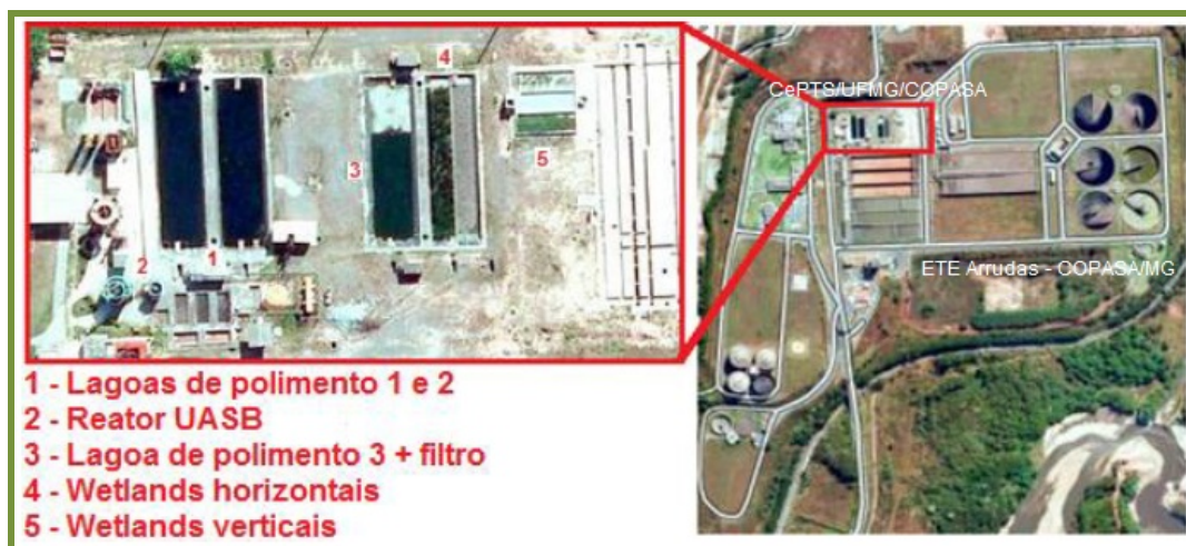
Figura 1 - Unidades experimentais de tratamento do CePTS/UFMG dentro das dependências da ETE-Arrudas/COPASA.
