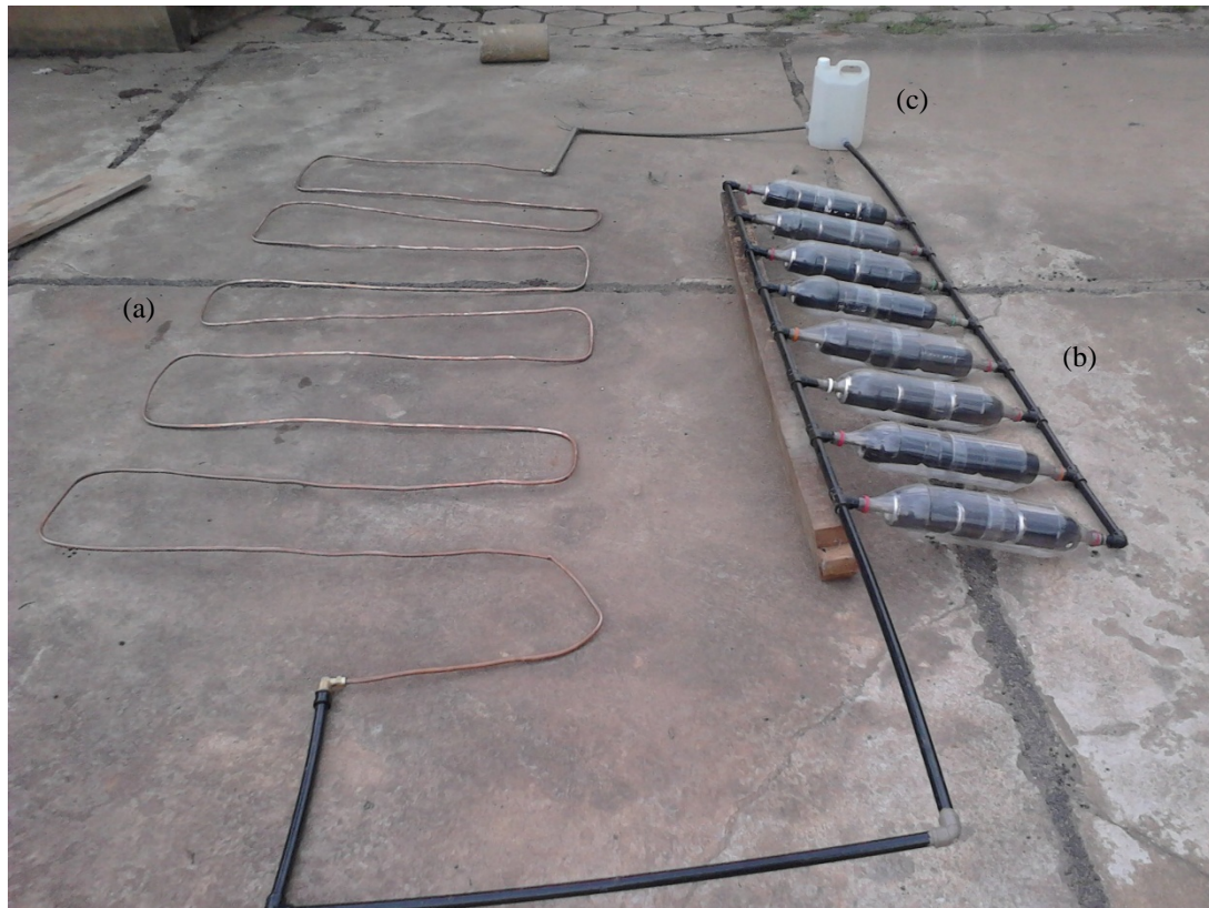
Figura 1 – Aquecedor solar usado na montagem do sistema definitivo: (a) Serpentina de cobre. (b) Placa coletora de energia solar. (c) Pequeno reservatório.
