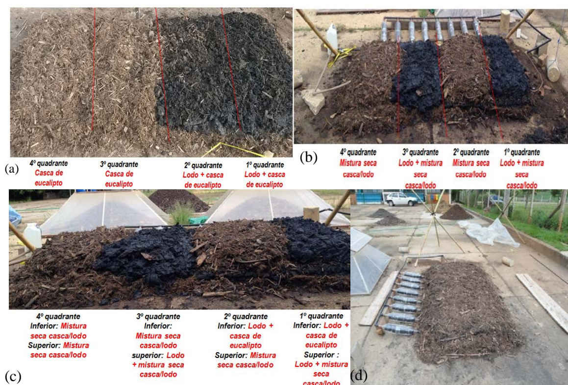
Figura 2 – Sistema de secagem com coletor solar e trocador de calor: (a) camada inferior dos quadrantes; (b) camada superior dos quadrantes; (c) camadas inferior e superior dos quadrantes; (d) pilha final.
