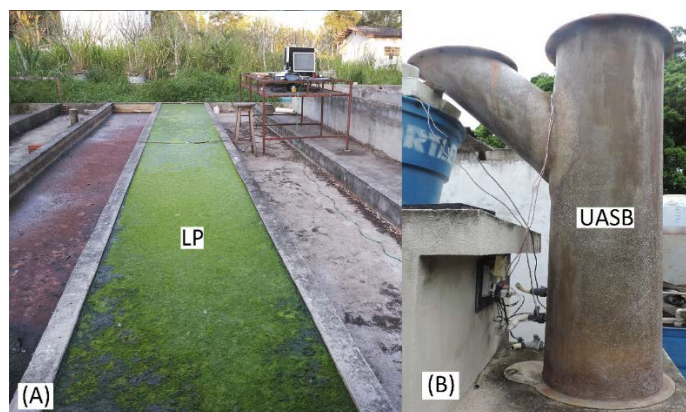
FIGURA 02: Imagem real de todo o sistema experimental – lagoas de polimento como pós-tratamento de um reator UASB.
