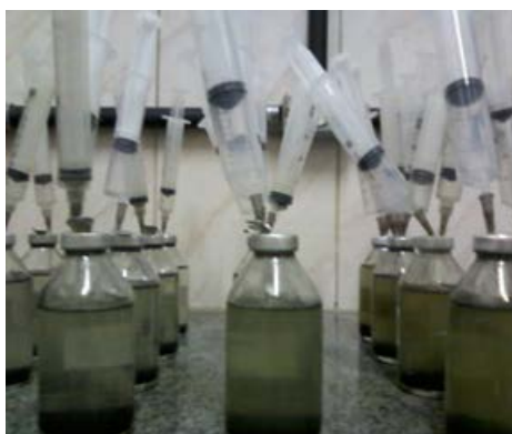
Figura 1: Ensaio de biodegradabilidade anaeróbia em andamento.
