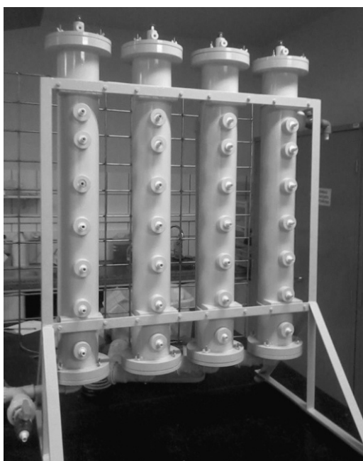
Figura 1: Reator anaeróbio compartimentado
