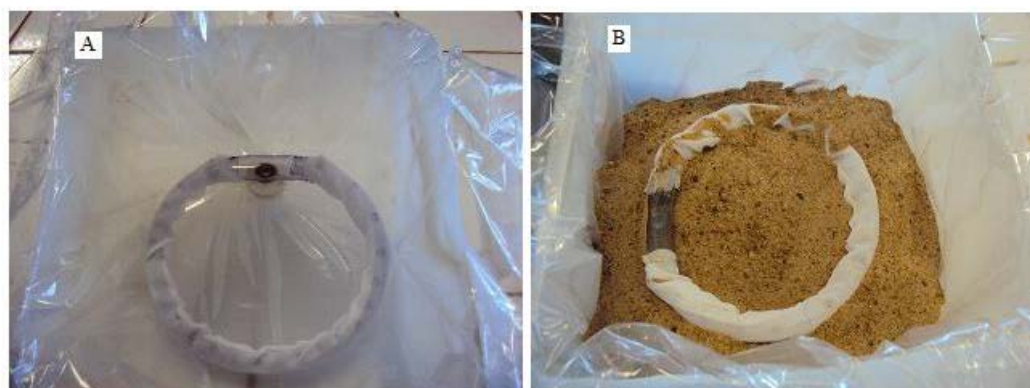
Figura 4 - Simulação de uma estação de fitotratamento de fluxo vertical demonstrando o (A) encanamento do sistema com (B) adição de material de recheio, areia.
